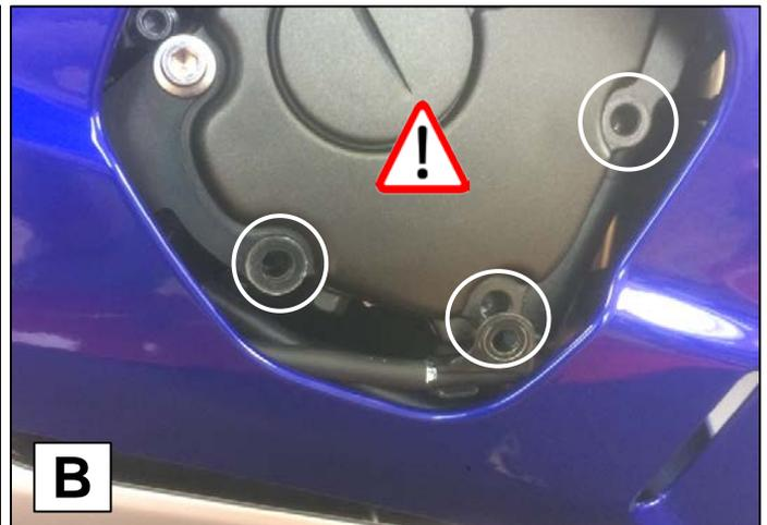
**A:** Entfernen Sie die 3 originalen Schrauben des Gehäusedeckels.
