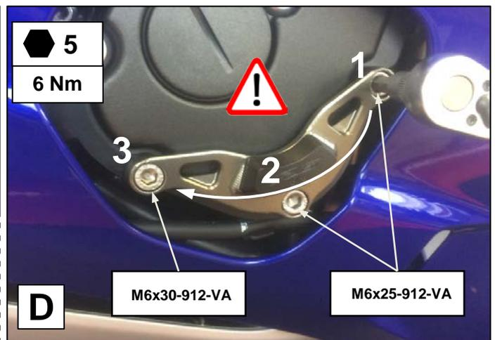
**C:** Setzen Sie den Motorprotector wie dargestellt an den Gehäusedeckel.
