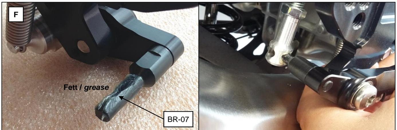
**F:** Fetten Sie den Bremsbolzen **BR-07** mit handelsübliches Industriefett, anschließend stecken Sie den Bremszylinder mittels Adapter **UAD03-23** auf den gefetteten Betätigungsbolzen **BR-07**.
