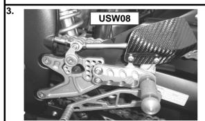
Fußrastenanlage anhalten und Schaltwelle USW07 beidseitig bis Anschlag gleichmäßig einschrauben, bis Umlenkhebel senkrecht zur Fußraste steht. Höhe des Schalthebels mittels USW08 einstellen und sichern.
