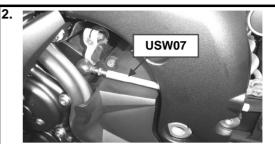
Schaltwelle USW07 einen Gewindegang am Kugelkopf Getriebeausgang einschrauben.
