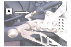
Abschließend Bremshebelhöhe an Bremsbetätigungsstift einstellen (A). Anschließend mit Mutter sichern. Bremslichtschalter einstellen.
