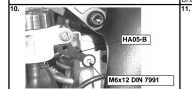
Halter HA05-\* an Bremsflüssigkeitsbehälter montieren und mit Schraube M6x16 DIN 7001 am Rahmen anschrauben.
