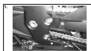
Linke Originalfußrastenanlage demontieren.
