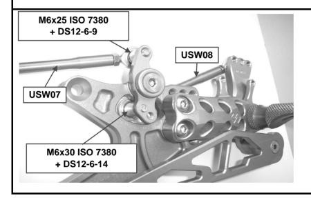
Achtung: Alle Teile der Fußrastenanlage müssen immer einen Mindestabstand von 5 mm zu anderen beweglichen Fahrzeugteilen haben.
