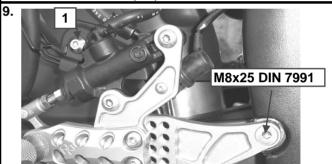
Grundplatten am Rahmen anschrauben. Hitzeschutzblech mit originalen Schrauben am Halter Bremsleitung anschrauben (1). Anschließend Bremszylinder mit Schraube M8x30 ISO 7380 und Si-Mutter M8 Din 985 an UHB01 anschrauben.
