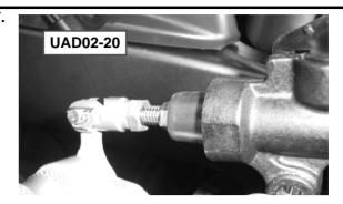
UAD02-20 an Bremszylinderstift anschrauben und Gabelkopf in Lagerbock einhängen. Mit Bolzen und Splint sichern.
