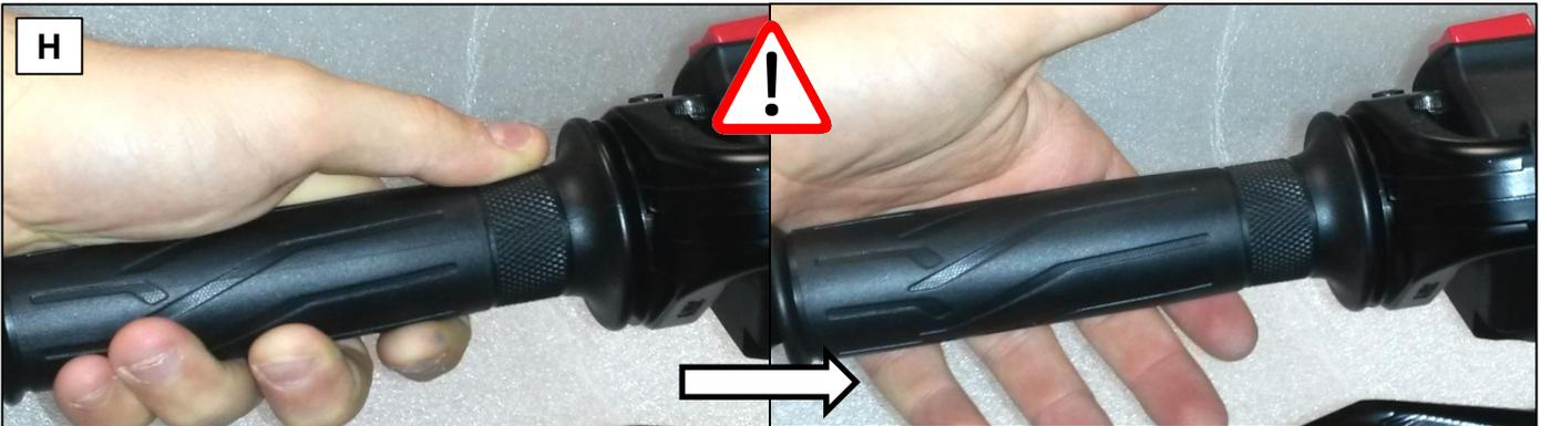
**H:** Es ist zwingend zu kontrollieren, dass der Gasgriff an beiden Lenkanschlägen nach dem ziehen und lösen nicht klemmt, sondern in die unbetätigte Grundstellung zurückspringt (komplett widerstandsfrei ohne leichtes Hängen)! Sollte der Gasgriff klemmen, sind die Gaszüge für die gewählte Verstellung in **Schritt G** zu kurz. Die Klemmen müssen nach vorne korrigiert werden!
