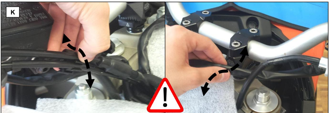
**K:** Überprüfen Sie per Hand auch das Spiel der Bremsleitungen (eventuell Kupplungsleitungen), Kupplungszüge und Kabelbäume in den beiden Lenkanschlägen. Diese dürfen auf keinen Fall gespannt werden beim Lenken, oder gar vor den Lenkanschlägen begrenzen!
