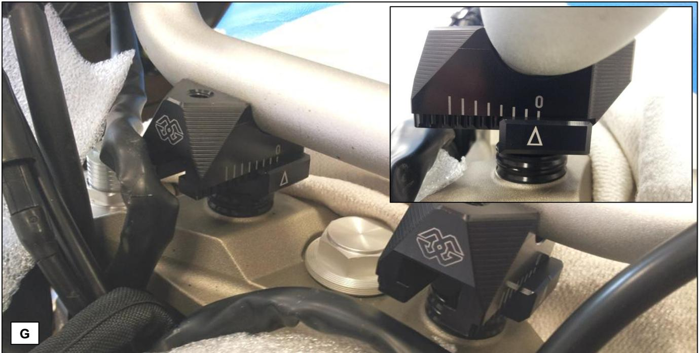
**G:** Setzen Sie die Lenkerklammern auf die Gabelbrücke (Schraubenende durch die Gabelbrücke). Die Einstellung der beiden Klemmböcke muss identisch sein und der Pfeil auf der Null (siehe [Schritt F](#)) als Ausgangsstellung! Das Bild zeigt die Ausrichtung der Klammern für die spätere Verstellung in Richtung Tank/ Fahrer ([Schritt I](#)).
