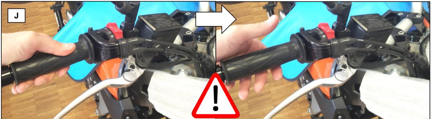
**J:** Es ist zwingend zu kontrollieren, dass der Gasgriff an beiden Lenkanschlägen nach dem Ziehen und Lösen nicht klemmt, sondern in die unbetätigte Grundstellung zurückspringt (komplett widerstandsfrei ohne leichtes Hängen)! Sollte der Gasgriff klemmen, sind die Gaszüge für die gewählte Verstellung in Schritt I zu kurz. Die Klemmen müssen nach Vorne korrigiert werden!
