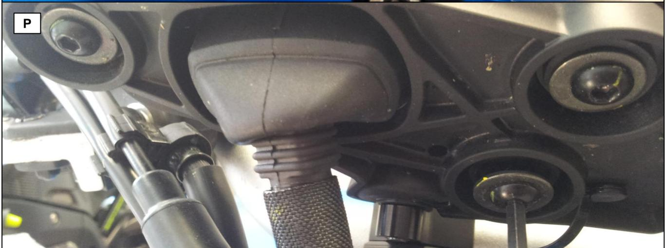
**O:** Schrauben Sie die Trägerplatte für die Tachoeinheit mit den beiden originalen Schrauben (Schrauben aus Schritt B) auf die Auslegernasen der oberen Klemmschalen.
