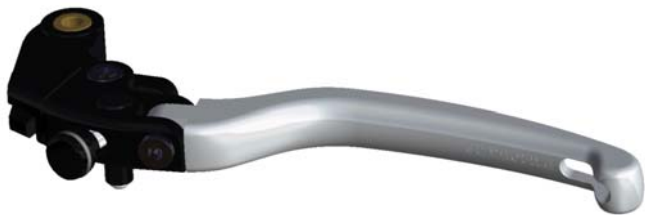
LCJ210 (Leva frizione completa) (Complete clutch lever)
