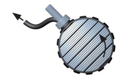
Für den vorschriftsmäßigen Betrieb muß das Lampenglas **3** mit seinen linienförmigen Streulinzen vertikal stehen. Ist dies nicht der Fall, führen Sie die folgenden Arbeitsschritte aus.
