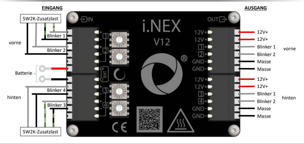
Eingang: Die Farben der fahrzeugseitigen Kabel können abweichen Zum Anschluss an die Batterie immer die mitgelieferten Kabel verwenden!
