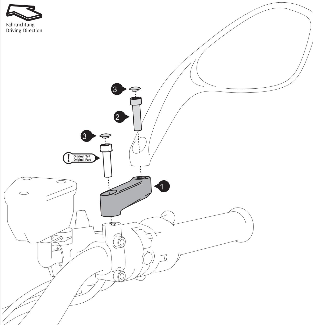
**Alle Schrauben mit flüssiger Schraubensicherung montieren!**
