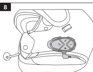
8 Die Steuerung montieren und das Kabel anschließen
