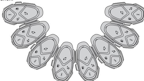
2. An der ersten Einheit + (UP), bis die LED rot / grün leuchtet. Der Vorgang wird automatisch abgeschlossen sobald alle Einheiten miteinander verbunden sind.
